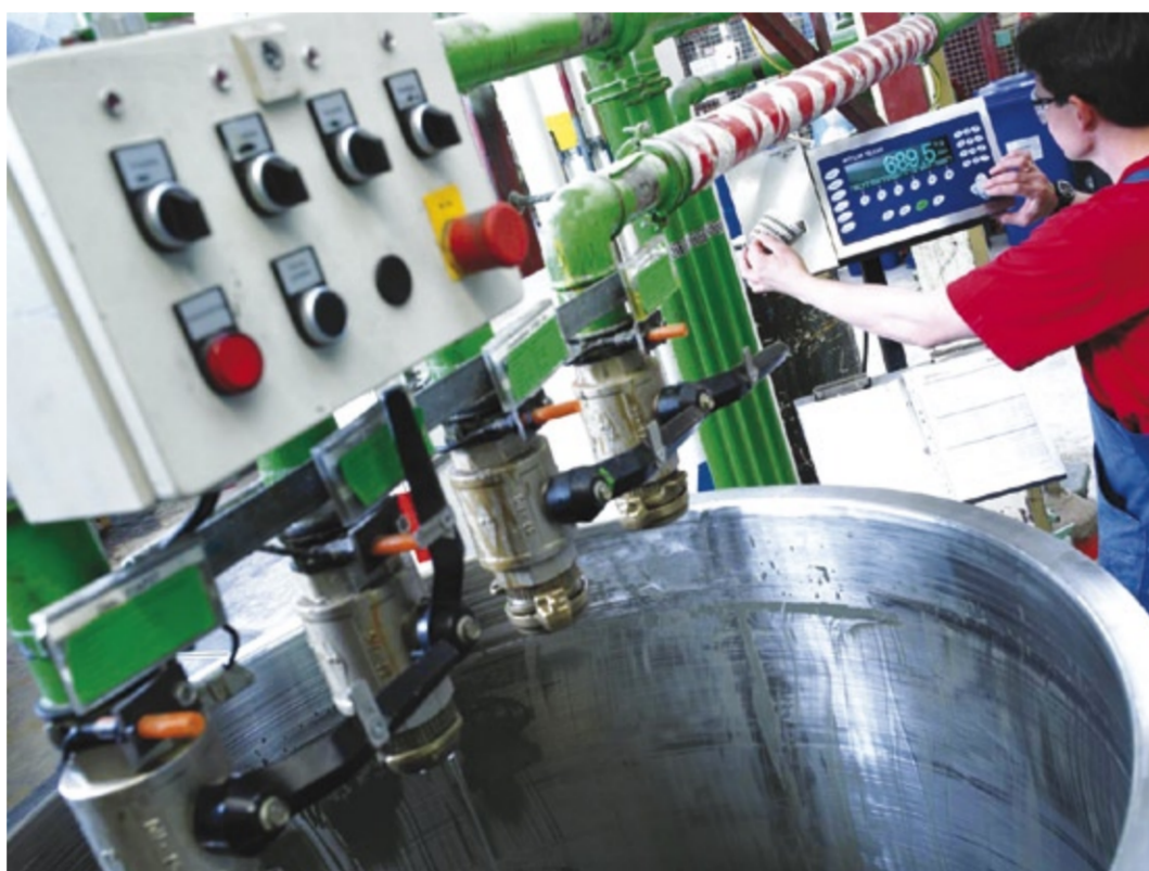
Mettler Toledo IND690 Wägeterminal zusammen mit Drucker (Modellreihe GA46) eingebunden in Prozessumgebung
