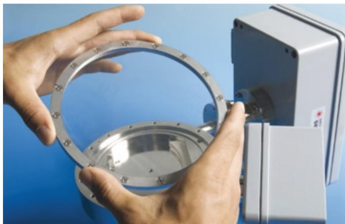
Abb. 2: Permeationsmesssystem für Ultrabarrierematerialien auf Basis von Laserdiodenspektroskopie
