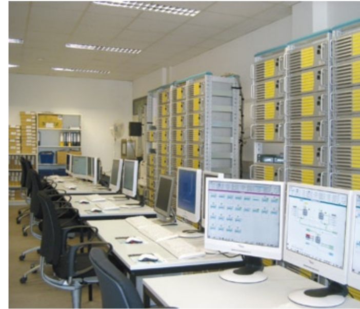
Abb. 2: In einem kompletten Testaufbau beim Systemintegrator Lang und Peitler wurde die mehr als 100 Simatic Rack-PCs umfassende Installation vorab geprüft, sodass die Inbetriebnahme am Factory Acceptance Test nach nur fünf Monaten erfolgreich abgeschlossen war.
