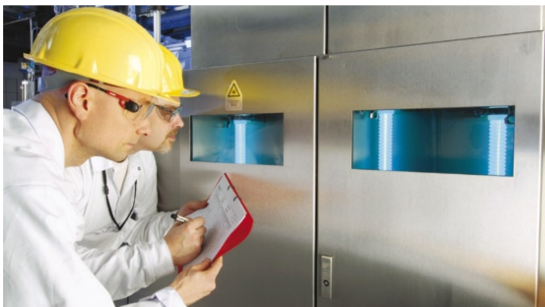
Abb. 1: Das erste UVivatic-Referenzprojekt bei Bayer HealthCare in Wuppertal. Dort werden Viren in Gewebeextrakten von Blutegeln inaktiviert.
