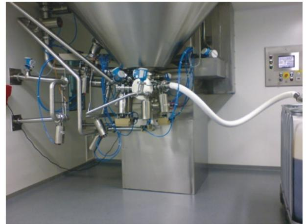
Abb.2: Die Vakuumprozessanlage Dinex 5200 zur Verarbeitung von flüssigen und halb festen Formen wurde bei ihrer Installation auf zwei Etagen und mehrere Räume verteilt.
