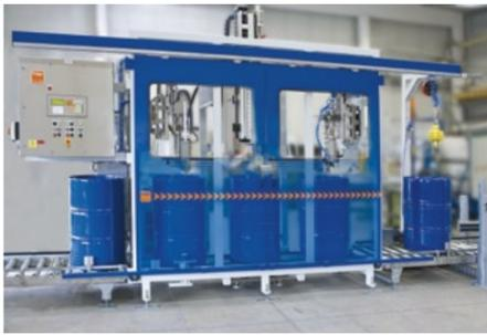
nochmals übertroffen. Alles ist produktionsbereit montiert und beim Einsatz im Ex-Bereich der Zone 1 gemäß den ATEX-Richtlinien ausgelegt und geprüft.
