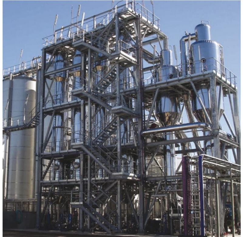
Abb.1: WegendeshohenEnergieverbrauchsvonVerdampferanlagendenkenvieleUnternehmendarübernach,ihrebestehendenAnlagen energetisch zu optimieren. GEAWiegand rüstet dies mit einer mechanischen Brüdenverdichtung aus, wodurch große Mengen an Heizenergie oder Frischdampf eingespart werden können. Im Bild: Verdampferanlage.
