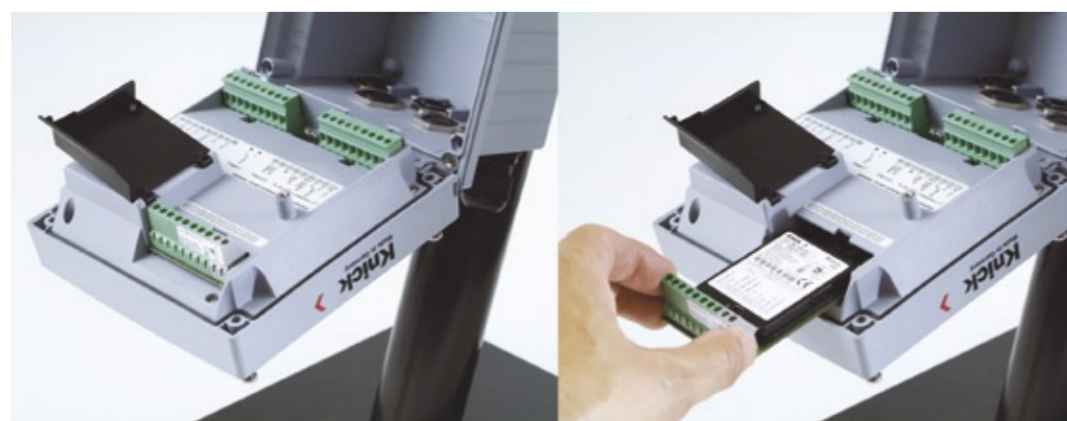
Abb. 3: Die gesamte Elektronik des Stratos Pro ist in getrenntem Modulbauweise gehalten und im Türmodul des Gerätes untergebracht.
