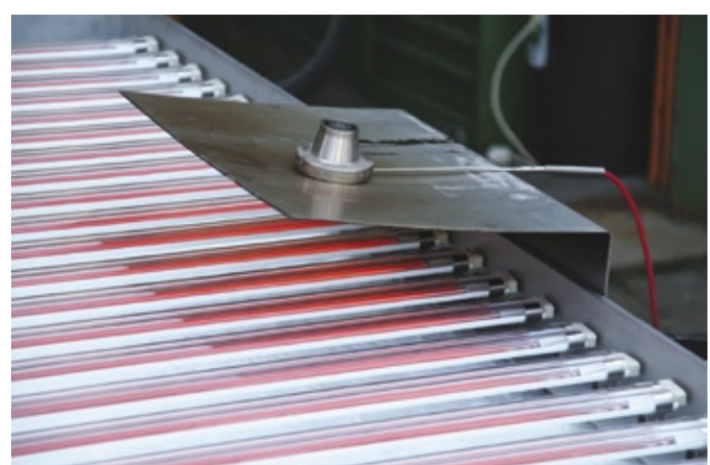
Das „Heizkissen“ mit 32 Infrarotstrahlern wurde nach erfolgreicher Erprobung in die Anlage integriert.
