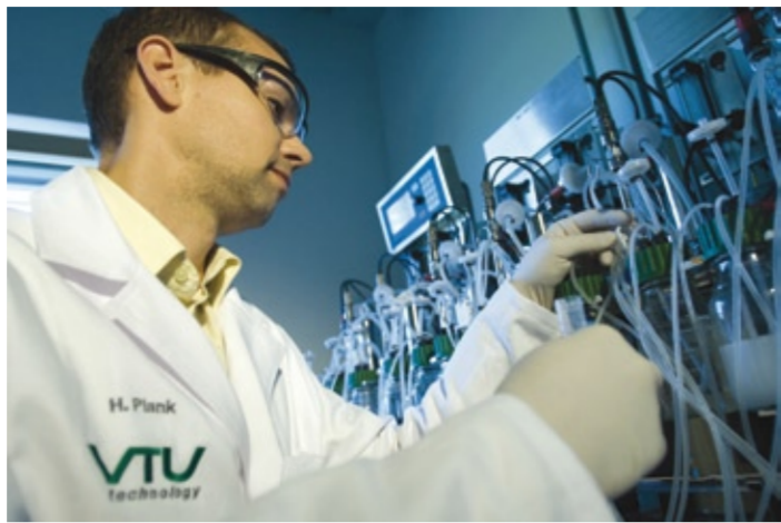
VTU Technology hat eine an der Technischen Universität Graz entwickelte und patentierte Exklusiv-Technologie erworben, durch die sich in der Hefe Pichia pastoris Proteine in hoher Menge und Reinheit herstellen lassen. Die Proteine werden zudem in das Fermentationsmedium sekretiert. Im Bild: Optimierung der Proteinproduktion in parallelen Multi-Fermentern bei VTU Technology.
