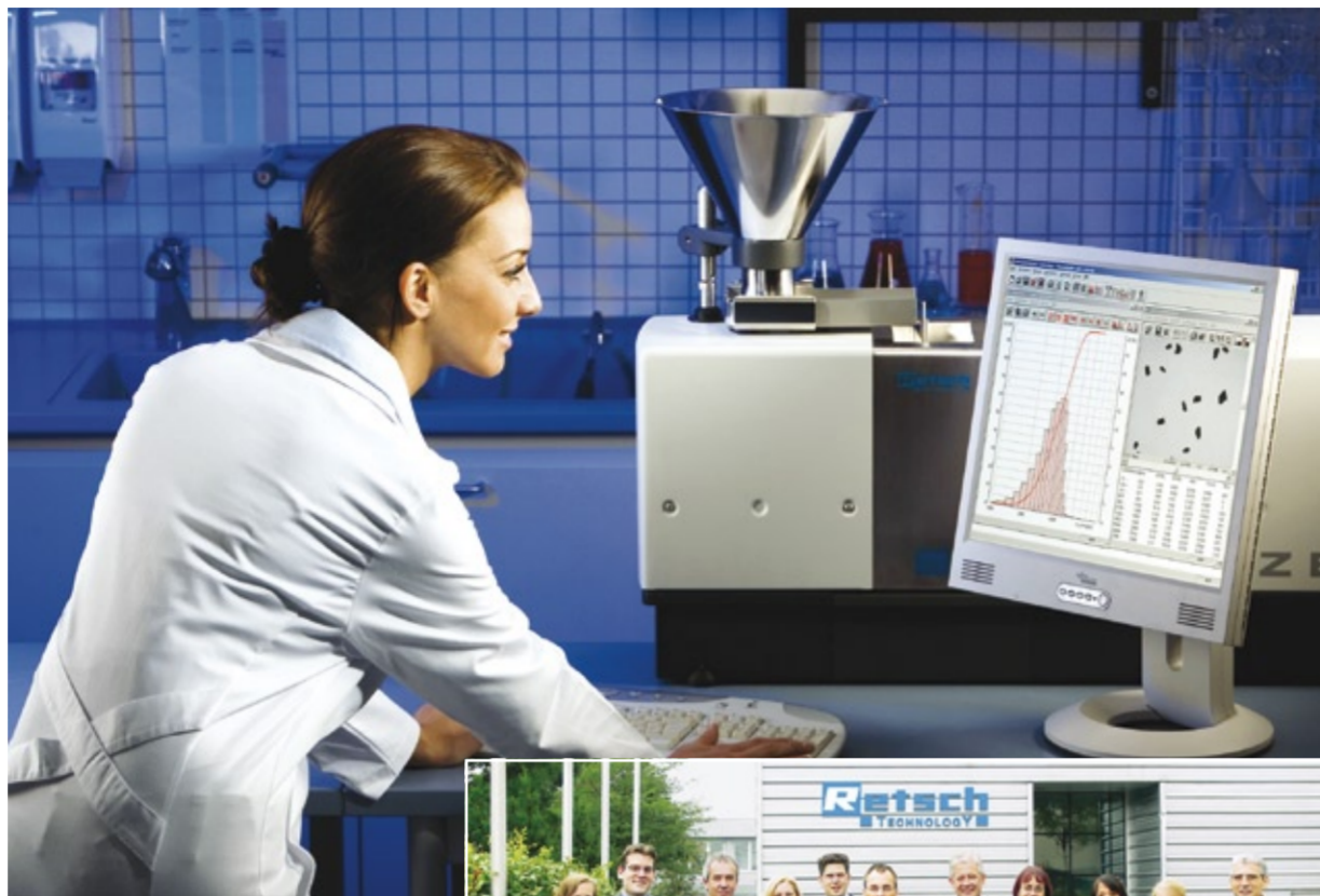
Zusammen mit der Jenoptik L.O.S. konzipierte Retsch Technology das Zwei-Kamera-System des Camsizer.
