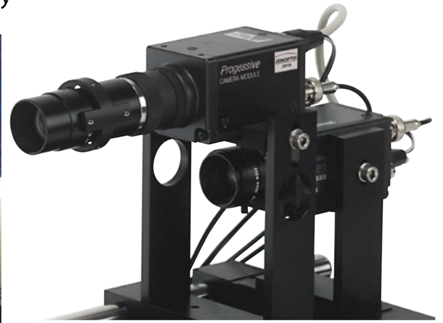
Zusammen mit der Jenoptik L.O.S. konzipierte Retsch Technology das Zwei-Kamera-System des Camsizer.
