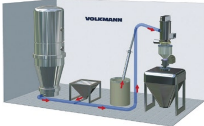
Die vielfältigen Variationsmöglichkeiten des Materialflusses bei einer Saugförderanlage.
