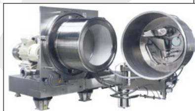
Horizontalschälzentrifuge 1300 mm
