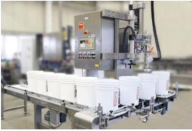
betrieblernen beim Betreiber gehören der Vergangenheit an. Je nach Produkteigenschaft wird eine Ausbringungsleistung von bis zu 600 Stück 20 l-Eimern pro Stunde erreicht. Dabei kommt die von Feige entwickelte und patentierte Produktstromregelung zum Einsatz, die im Zusammenspiel mit
