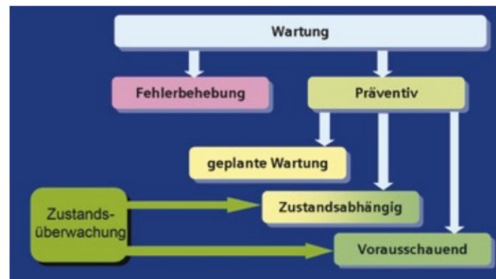
Abb. 1: Mit der vorausschauenden Wartung können ungeplante Stillstände minimiert, das Investment geschützt, und die Anlagensicherheit erhöht werden
