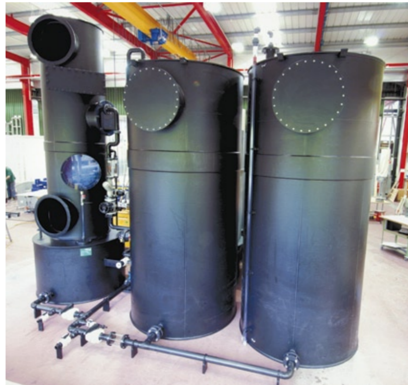
Abb.1: NH 3 -Notwäscher aus Polyethylen (PE) mit zwei Waschwassertanks. Anstelle von Waschwassertanks kann das Waschwasser auch konstant abgeschlammmt werden.
