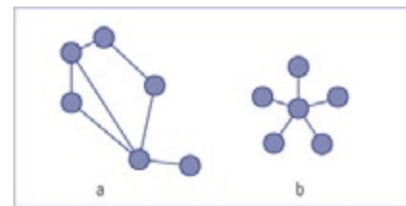
Netzstrukturen für die Teilnehmerverbindungen an einem Ethernet-Bus: a) Maschenstruktur b) Sternstruktur
