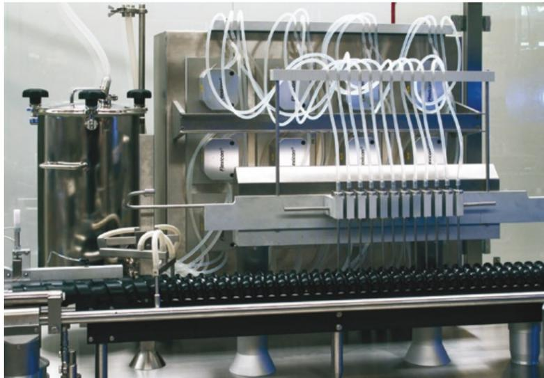
Abb. 2: Peristaltik-Füllsystem in Kombination mit 100% IPC. Bei einem Füllvolumen von 30 ml werden hier bis zu 300 Behälter/Min befüllt. Die zerstörungsfreie Inprozesskontrolle führt zu einer maximalen Nutzung der produzierten Arzneimittelmenge.
