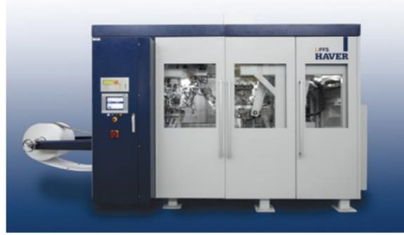
und eichgenau in Höchstgeschwindigkeit zu befüllen. Die Abfüllung in flexible Kunststoffsäcke bietet eine sowohl ökonomische als auch ökologisch attraktive Alternative zu den sonst üblichen Packmitteln – durch einfacheren Transport sowie geringere Herstellungskosten der Leergebinde.
