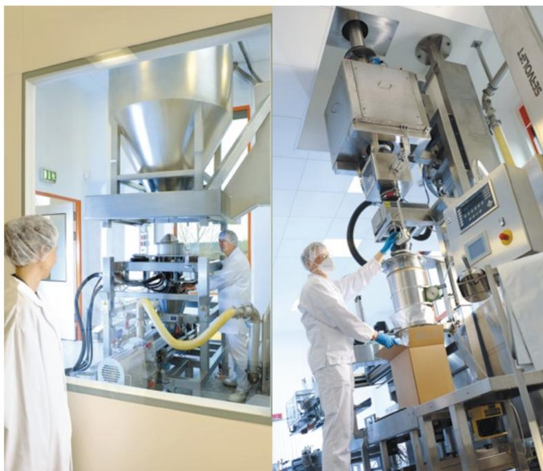
Abb. 3: Der Austrag des Mischgutes aus dem Mischer erfolgt im geschlossenen System über eine Kegelentleerung, bei der die Außenluft nicht mit dem Füllgut in Berührung kommt. Abb. 4: An der Abfüllstation der neuen Mischanlage kann optional noch ein geschlossenes System über eine Kegelentleerung, bei der die Außenluft nicht mit dem Füllgut in Berührung kommt, abgefüllt und verschweißt werden.
