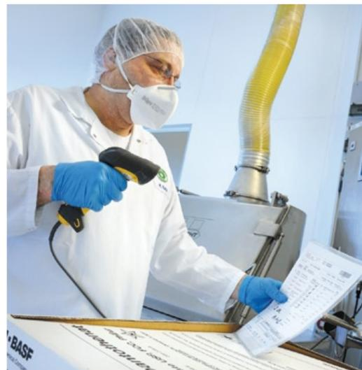
Abb. 2: Beim Verwiegen der Aufgabestation der neuen Mischanlage lässt sich sämtliche Produktzugaben über ein maßgeschneidertes EDV-Programm einscannen.
