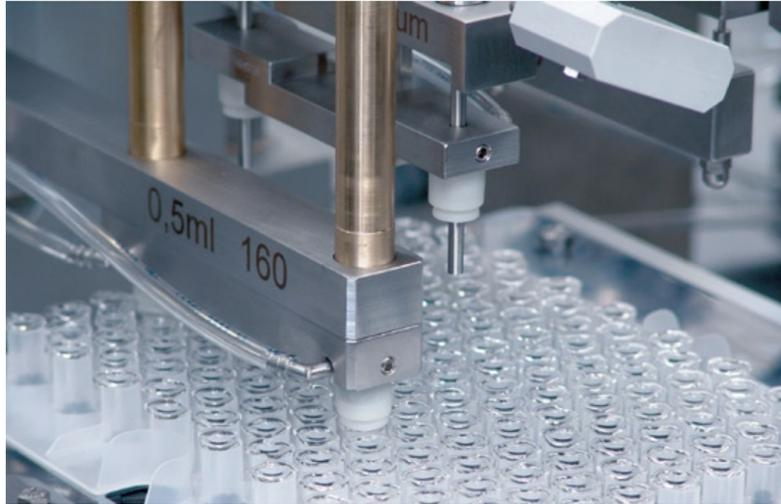
Abb. 1: Auf Basis der verschiedenen Füllsystem-Typen entstehen Sonderversionen – hier Vakuumfüllen.
