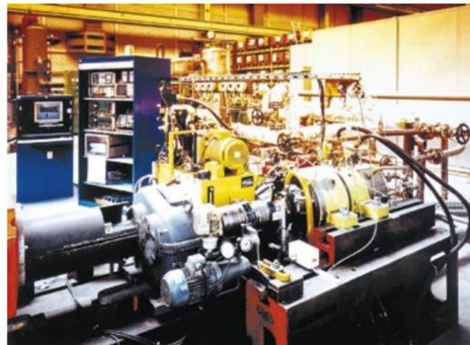
Abb. 3: Der tribologische Prüfstand von Sulzer Pumps liefert wertvolle Informationen über Oberflächen. Dieses Wissen ermöglicht die Auswahl geeigneter Werkstoffe für anspruchsvolle Anwendungen.
