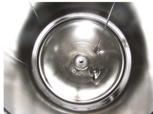
Abb. 2: Behälter nach dem Derouging mit Diruneutra
