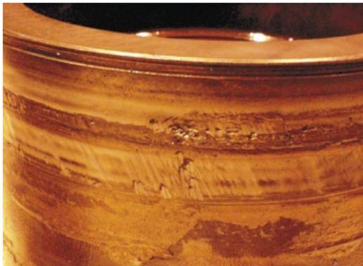
Abb. 1: Buchse des Entlastungskolbens einer Pumpe, durch Verschleiß beschädigt. Verbesserte Oberflächen führen unter anderem zu erhöhter Betriebssicherheit. Durch tribologische Forschung kann Sulzer Pumps Zuverlässigkeit und Leistungsfähigkeit gewährleisten.
