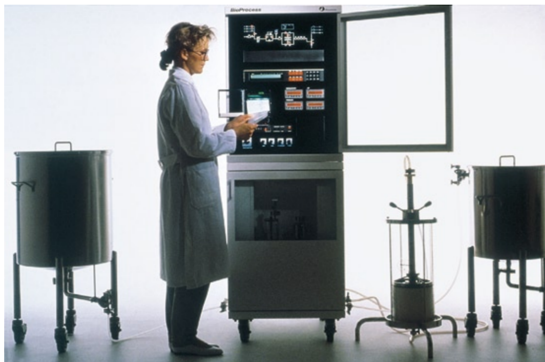
Abb. 1: Bioprocess-System 007 mit C3 PLC-Steuereinheit aus den späten 1980ern
