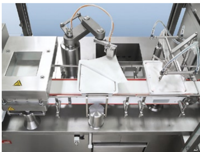
Abb. 2: Automatisches tub-Öffnen (ATO) mit Vorerwärmung, Greifer und Pick- und Place-Einheit für das Entfernen der inneren Tyvek-Folie
