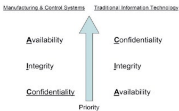
Abb. 2: In produktionsnahen IT-Systemen steht der Schutz der Verfügbarkeit (Availability) an erster Stelle. Quelle: ISA 99
