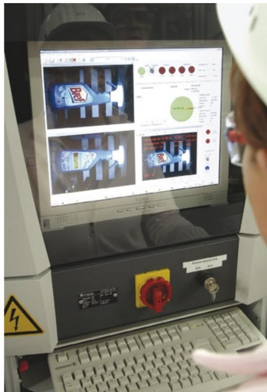
Abb. 1: Fehlerhafte Gebinde werden automatisch ausgeschleust. Der Monitor zeigt die Fehlerbilder numerisch und statistisch an.
