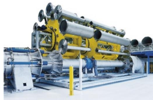
Abb. 6: Kalibrieranlage. Seit Herbst letzten Jahres steht bei Endress + Hauser Flowtec in Reinach in der Schweiz die weltweit genaueste Produktionskalibrieranlage mit einer akkreditierten Messunsicherheit von 0,015 %. Damit kann das Unternehmen für seine Coriolis-Gerätefamilie eine lückenlose und 100 %ig rückführbare Genauigkeit von 0,05 % nachweisen. Durch diese hohe Messgenauigkeit können z. B. in der Petrochemie beträchtliche Kosteneinsparungen erzielt werden.
