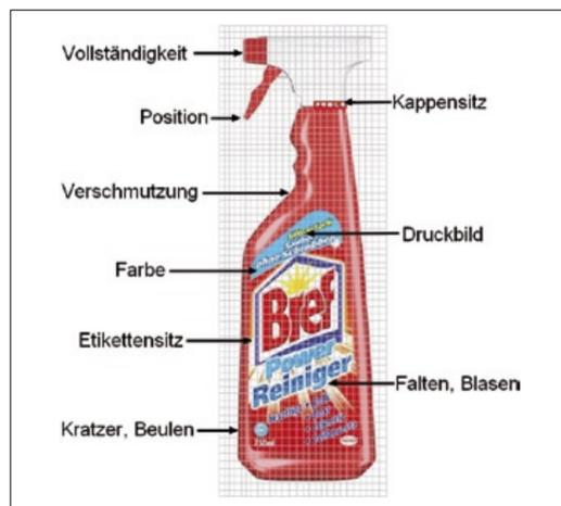
Abb. 2: Das digitale Kamerabild wird in tausende Kästchen mit definierter Toleranzgrenze zerlegt.
