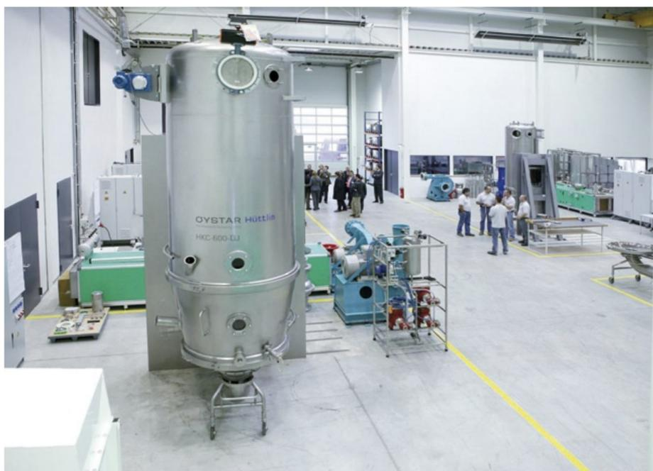
Abb. 2: Die HKC 600 DJ von Oyster Hüttlin für Trocknung, Granulierung und Coating.
