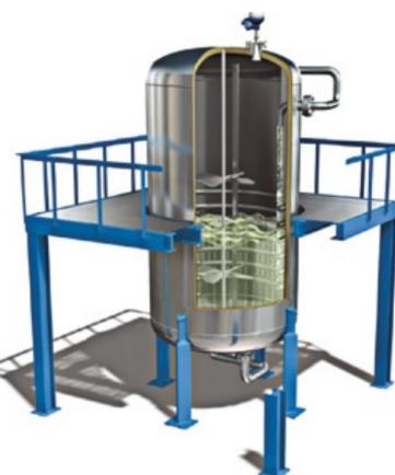
Abb. 4: Die Messung mit berührungslosem Radar wird weder durch störende Einbauten wie Rührer oder Heizrohre, noch durch runde Behälterböden beeinträchtigt (Rosemount Modell 5400).
