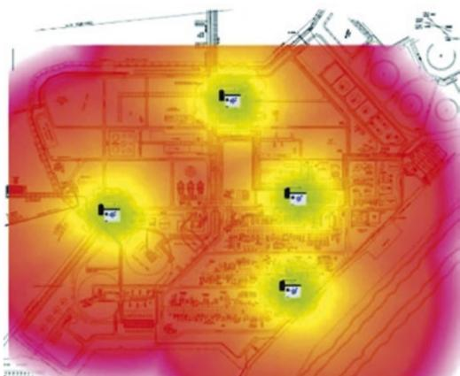
Abb. 2: Reichweiten von Access Points und Interferenzen anderer drahtloser Netze müssen sorgfältig geplant und anschließend per On-Site-Survey verifiziert werden
