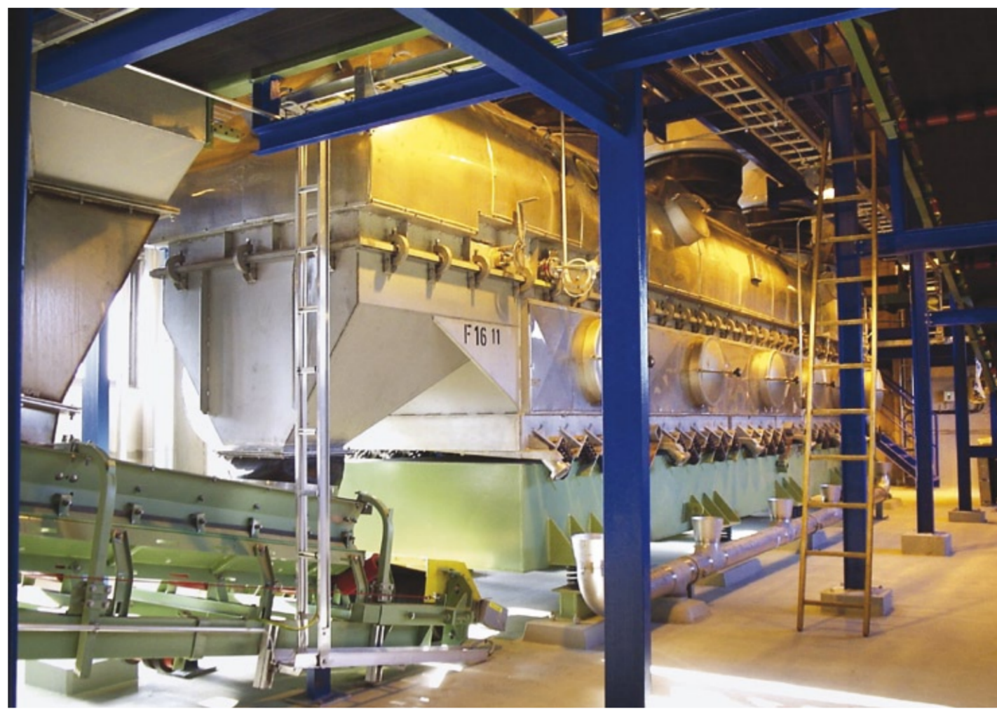
Abb. 1: Wirbelschichtrockner für die Vortrocknung von Grünsalz (Eisensulfat-Heptahydrat), das in großen Mengen als Nebenprodukt bei der TiO_2 -Herstellung im Sulfat-Verfahren anfällt. Das Grünsalz wird als Nebenprodukt für die Zement-, Düngemittel- und Pharmaindustrie sowie zur Wasseraufbereitung vermarktet. Voraussetzung dazu ist eine sehr schonende und kontrollierte Trocknung des Grünsalzes, d.h. das Kristallwasser darf nicht ausgetrieben werden.
