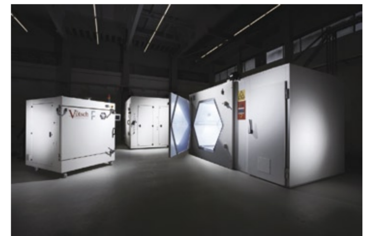
Drei große Mikrowellen-Prozessanlagen im neuen Versuchszentrum im Forschungszentrum Karlsruhe.
