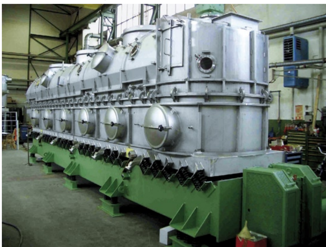
Abb. 3: Im Fließbettrockner wird das Grünsalz schonend weitergetrocknet
