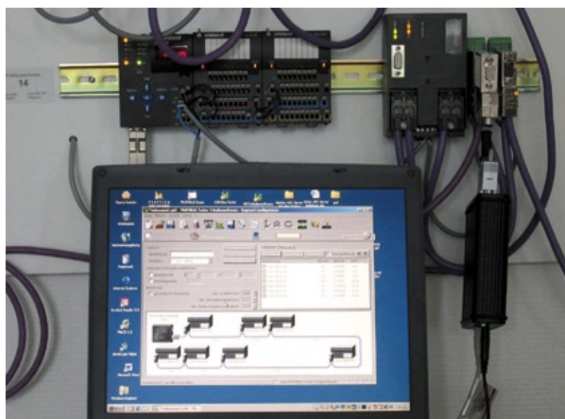
Abb. 1: Mittlerweile bietet der Markt für übliche Busse wie beispielsweise ASI-, CAN-, Profibus oder das Industrial Ethernet Diagnose-Tools, mit denen Anlageninstandhalter deren Zustand ermitteln können.
