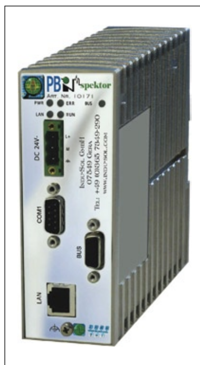
Abb. 2: Automatisierte, permanente Feldbusüberwachung: Ein Hardwaremodul als dezentraler Busmonitor überwacht den logischen Datenverkehr in Feldbussen und eine entsprechende Software zeigt dessen Zustand an.
