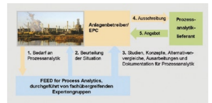
Abb. 3: FEED for Process Analytics setzt ganz am Anfang des Lebenszyklus einer Prozessanlage an, da hier die Entscheidungen fallen, die letztendlich Leistung, Sicherheit, Kosten und den ROI bestimmen.
