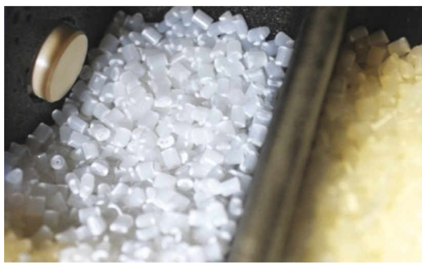
Abb. 2: Auch wenn es heiß hergeht, wie bei dieser Maschine zur Heißleimverarbeitung, eignen sich kapazitive Sensoren für die Füllstandsmessung.
