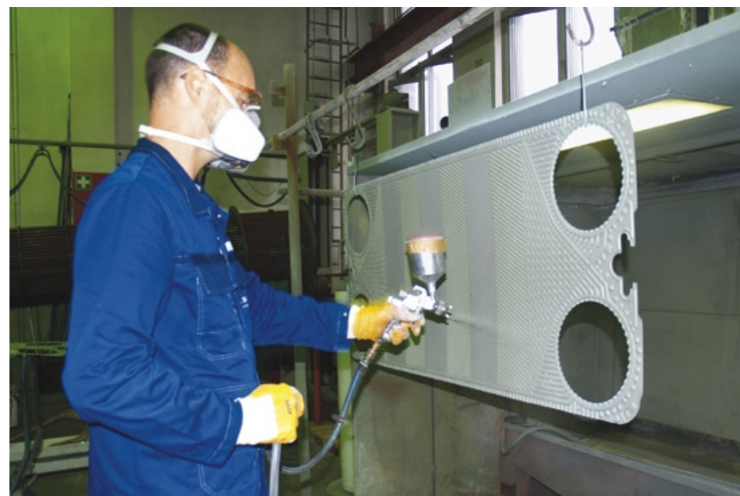
Antihafbeschichtungen von BASF werden in maximal drei Schichten im Spritzverfahren aufgebracht.
