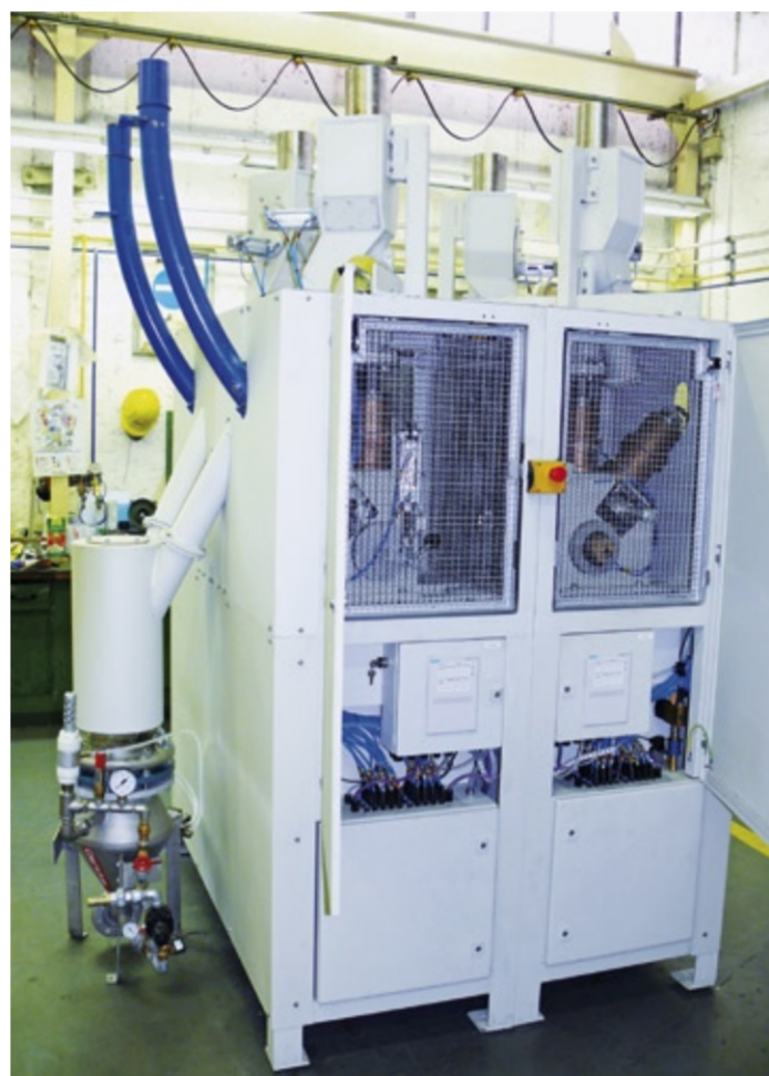
Vierfach Sendestation in ultrakompakter Bauweise mit den entsprechenden Dosiereinheiten
