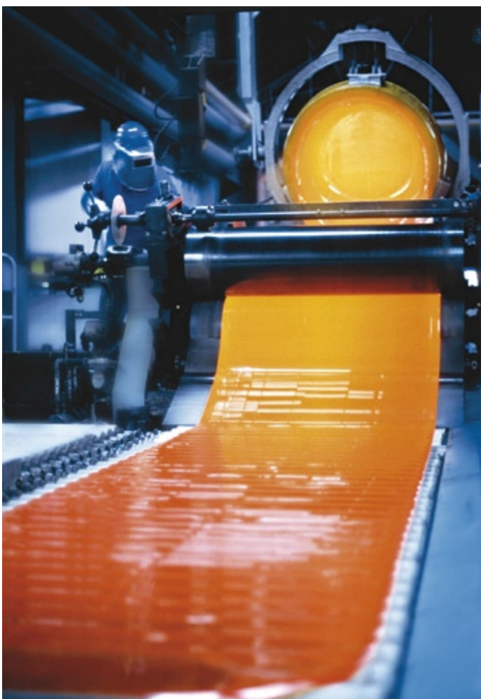
Produktion bei Schott: Das geschmolzene Spezialglas wird durch Walzen in die gewünschte Form gebracht.
