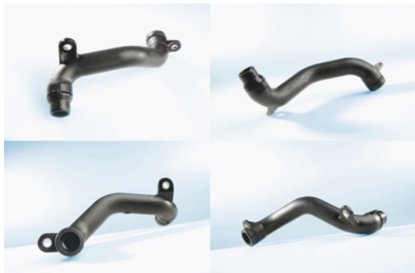
Eines der ersten in WIT gefertigten Kühlwasserrohre aus PA 66 besteht aus Durethan DP AKV 30 X HR EF.
