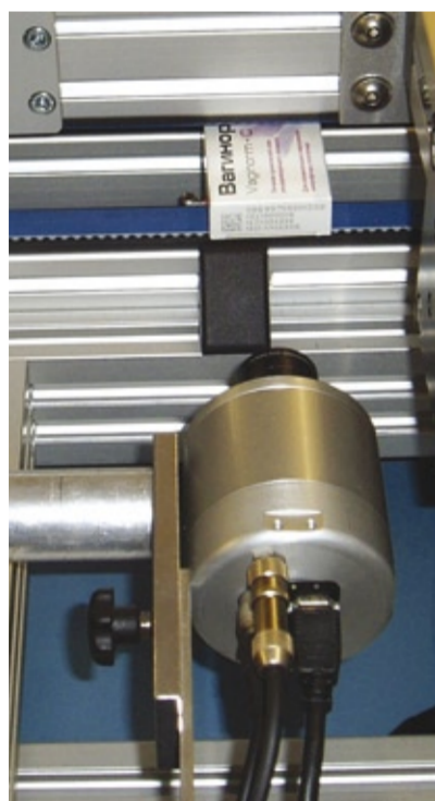
Die Kamera LKS 5Security überprüft die aufgedruckte Klarschrift mit den Inhalten des EAN Data Matrix Codes/ECC 200.
