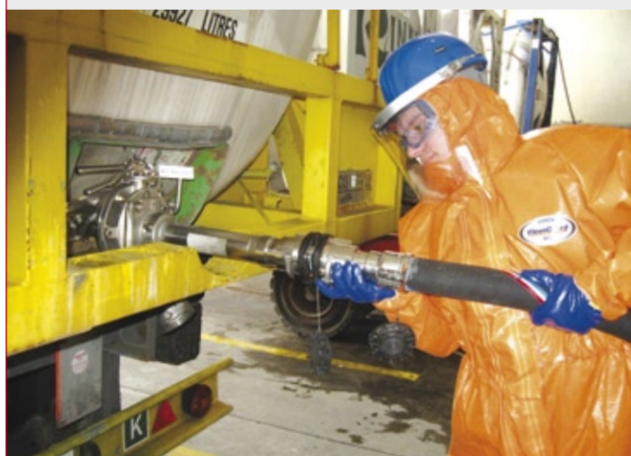
Abb. 2: TKU mit Rohrverlängerung im Realeinsatz
