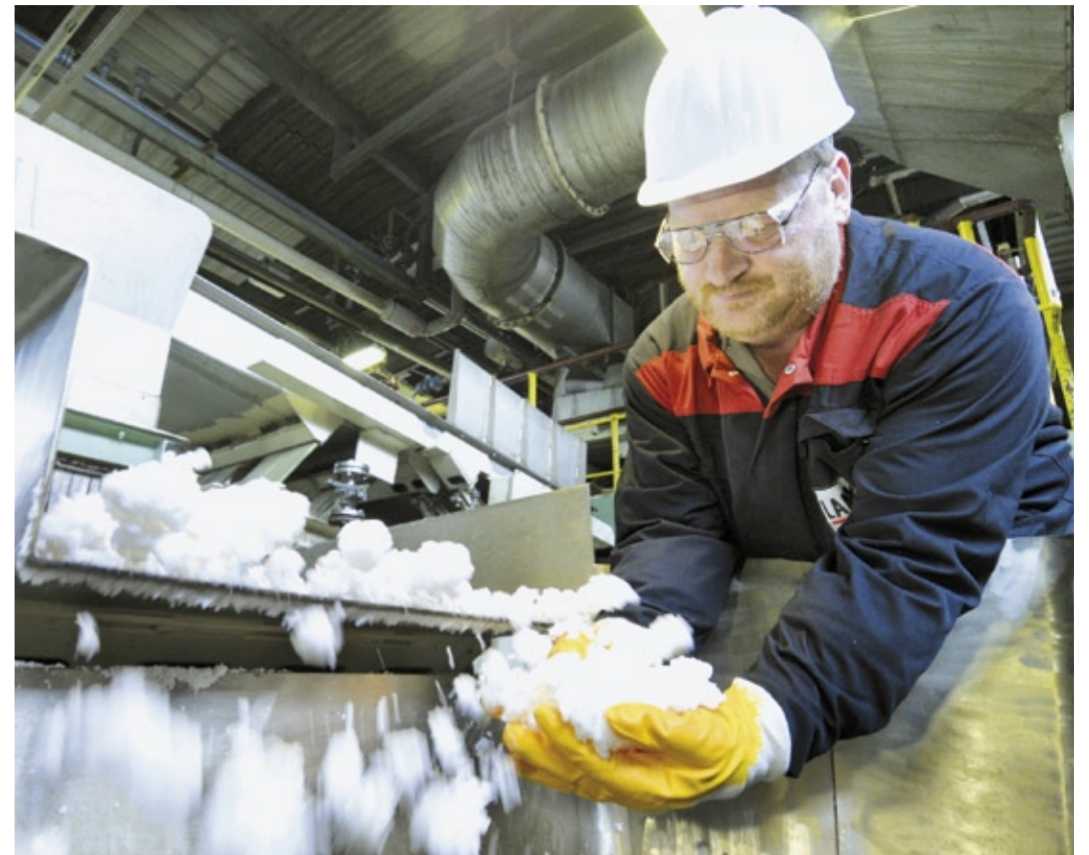
Kautschukproduktion am Lanxess Standort Dormagen. Ein Mitarbeiter kontrolliert Kautschukflocken zur Weiterverarbeitung.
