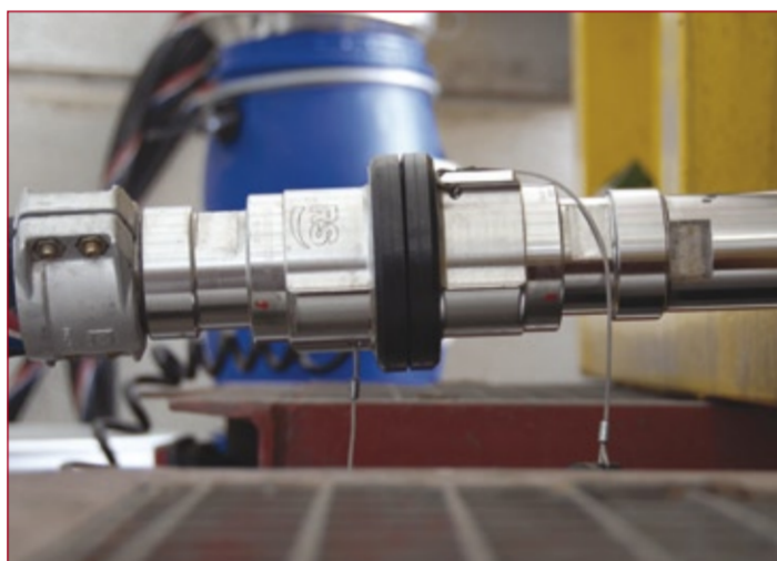
Abb. 1: Unisex mit vollem Durchfluss: Da es weder Vater- noch Mutterteil gibt – beide Seiten sind identisch –, lassen sich mit der TKU Schlauchleitungen problemlos in beiden Fließrichtungen einsetzen. Darüber hinaus macht die TKU den Einsatz eines Drehgelenks überflüssig, da dessen Leistungsmerkmal direkt in die TKU integriert ist.
