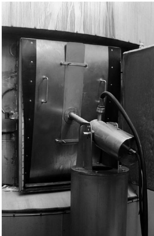
Einsatzsituation für den Tanko-JX 70: Das CIP-Reinigungsverfahren beschleunigt Säuberungsarbeiten, macht sie preiswerter und wesentlich sicherer. (Bild: AWH)
