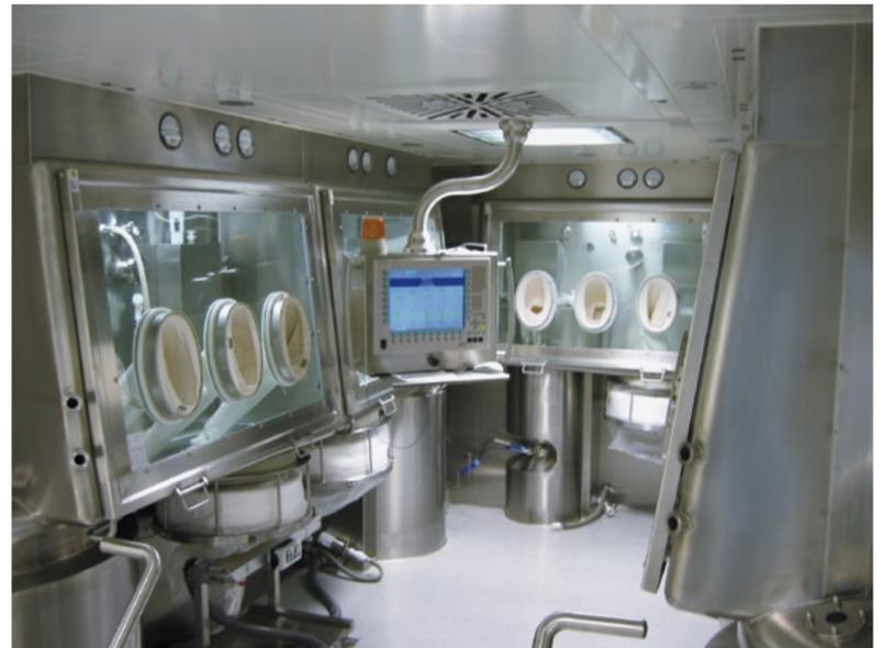
Abb. 1: Die Anlage mit fünf Isolatoren mit zugehörigen Ansatzbehältern kann sehr flexibel genutzt werden und ermöglicht das Herstellen von hochaktiven Produkten unter höchstem Bedienschutz.
