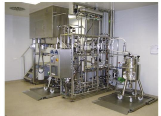
Abb. 2: Die Ansatzanlage mit Filtratbehälter rechts und Rückseite des Isolators links.
