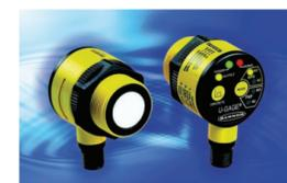
Mit der T30UX-Reihe stellt Turck neue U-Gage-Ultraschallsensoren vor, die dank eines leistungsfähigen Schallwandlers und einer integrierten Temperaturkompensation deutlich genauere Messwerte liefern als vergleichbare Produkte. Die IP67-Sensoren mit Erfassungsbereichen von bis zu 3 m eignen sich dank kurzer Blindzonen von nur 10 % der Maximalreichweite für Anwendungen in der Automobilpro-
