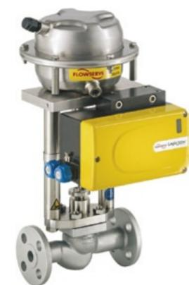
Dampfkühler Einspritzungsdosierung. Das Regelventil Kämmer Smallflow 385000 ist innerhalb der Produktpalette von Flowserve die „-Variante. Anschlussweiten bis 1“ oder DN 25 sind möglich. Das spezielle kompakte Design des Gussgehäuses unterstützt Druckstufen bis CL 600 bzw. PN 160 bei einem maximalen KVS-Wert von 4.
