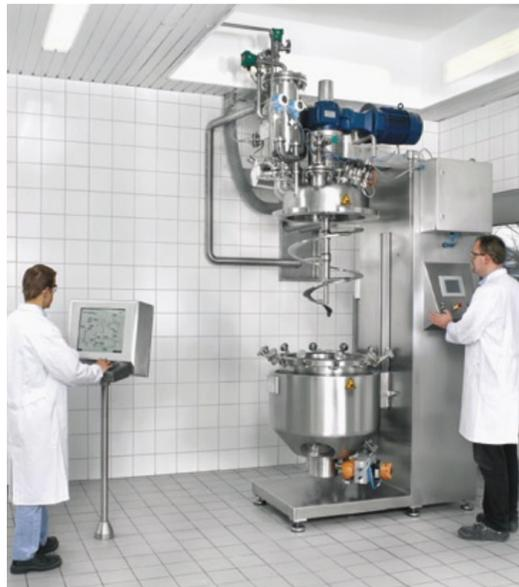
Abb. 1: Technikertrockner mit Feststoff-Rührorgan
