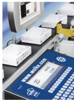
lackierten oder nicht saugfähigen Oberflächen. Durch einen höheren Anteil an Alkohol-basierenden Lösungsmitteln hat sich die Bandbreite der bedruckbaren Materialien vergrößert.
