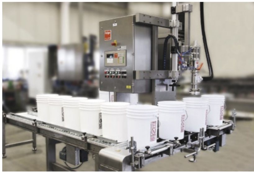
Abb. 1: Bei der vollautomatischen „Plug & Fill“-Anlage Typ 34 von Feige für Eimer und Kanister werden die Abfüllzeiten durch eine Produktstromregelung auf ein Minimum reduziert.
