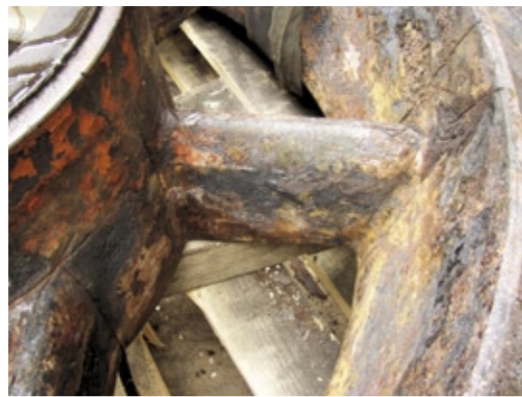
Abb. 1: Korrodierte Ablaufrinne einer Zentrifuge
