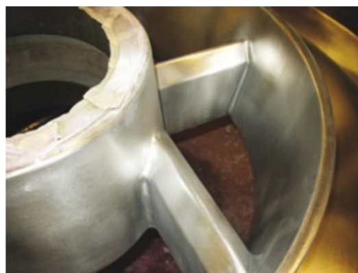
Abb. 2: Erneuerte Ablaufrinne mit HC-Auskleidung
