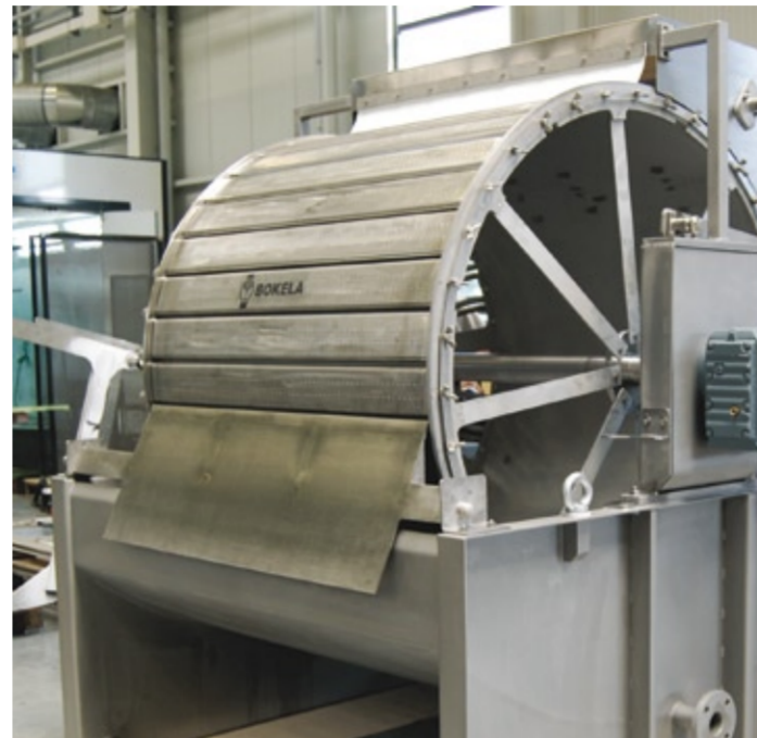
Abb. 1: Vakuum-Trommelfilter von Bokela überzeugen durch ihre hohe Leistungskapazität, ihre hervorragende Kuchenwaschung und durch innovative Designmerkmale.
