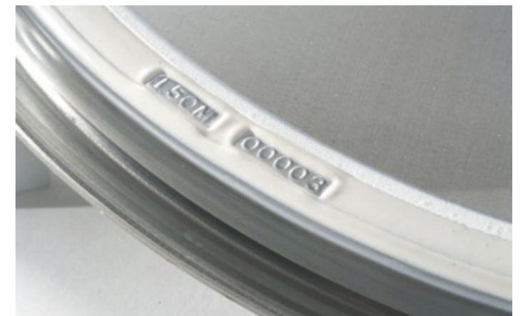
Abb. 4: Produkte- und Seriennummer in einer Stahlplatte eingestanz
