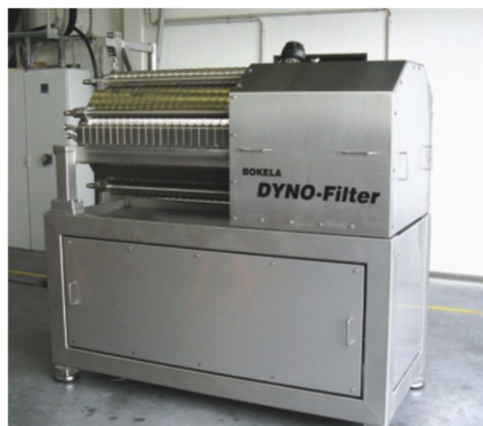
Abb. 3: Das Dyno-Filter von Bokela ist ein spezielles, dynamisches Crossflow-Filter zur Ultra- und Mikrofiltration, mit dem Suspensionen schnell, produktchonend und konkurrenzlos hoch aufkonzentriert werden können.
