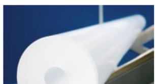
Platz 1: Entwicklung von fluordotierten Quarzglasrohren, die eine besonders effiziente Herstellung von hoch biegsamen optischen Quarzglasfasern ermöglichen.
