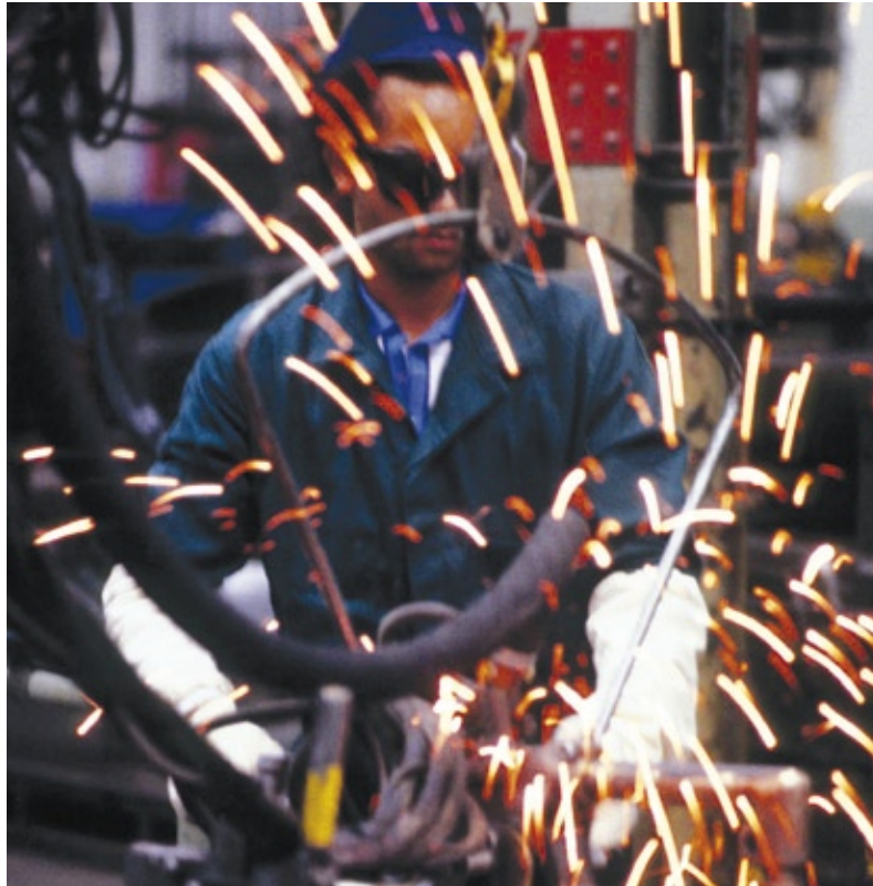
Funken und Schmelze können zum Teil stundenlang schweben, bevor offene Flammen ausbrechen.
