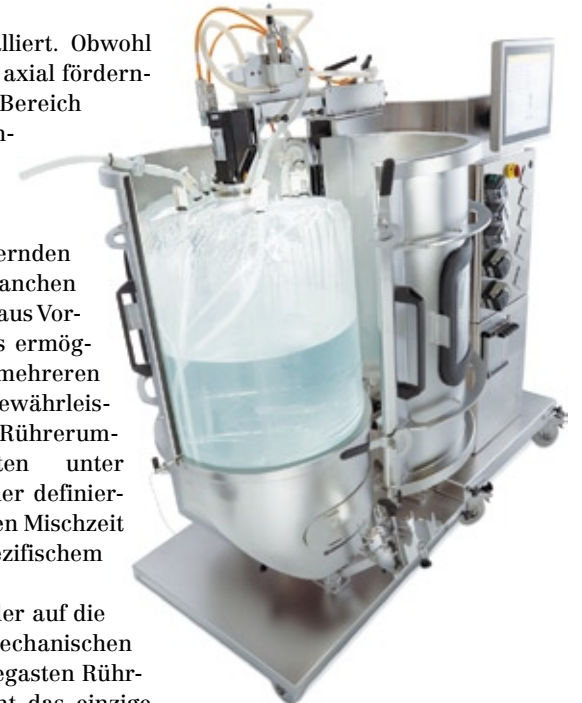
Abb. 1: Die Einwegbioreaktor-Familie Biostat Cultibag STR erlaubt Zellkulturvolumina von 50 l bis 1.000 l und ist prädestiniert für die Produktion monoklonaler Antikörper und Impfstoffe.
