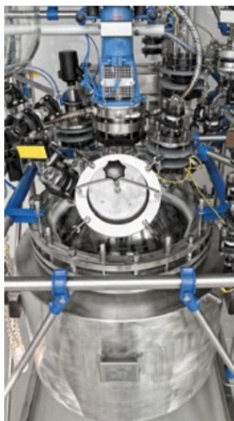
Im Tieftaktreaktor können in Lahr Reaktionen bis zu einer Temperatur von -100 °C durchgeführt werden.
