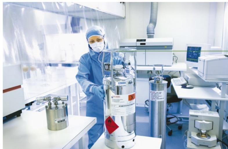
Abb. 2: Precursor werden statt in Gasflaschen in speziellen Kanistern geliefert
