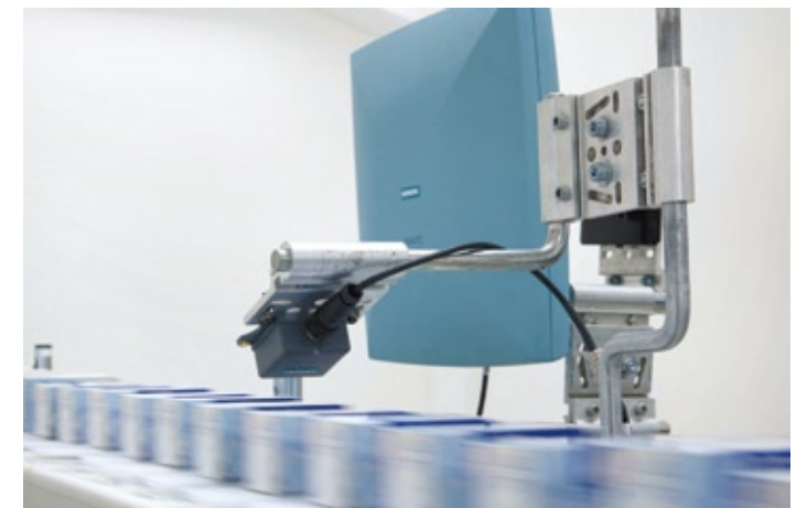
Abb. 3: Einzelidentifikationsprozess bei über 1 m/s
