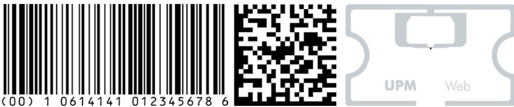
Abb. 1: Vergleich von 1-D-, 2-D-Barcode und Transponder
