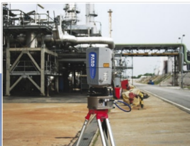
Die mit Laserscannern generierten 3-D-Modelle sind auf vielen CAD-Systemen einsetzbar.
