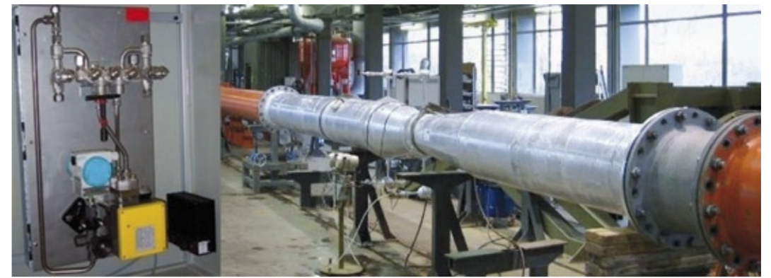
Dampfverrechnungsmessung mit Venturirohr nach DIN EN ISO 5167
