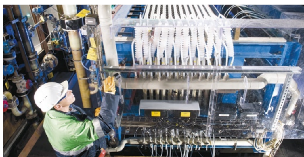
Erstmals sollen die Sauerstoffverzehrkathoden von Bayer MaterialScience in den von Uhdenora entwickelten Elektrolysezellen eingesetzt werden, um im industriellen Maßstab Chlor auf Salzbasis herzustellen.
