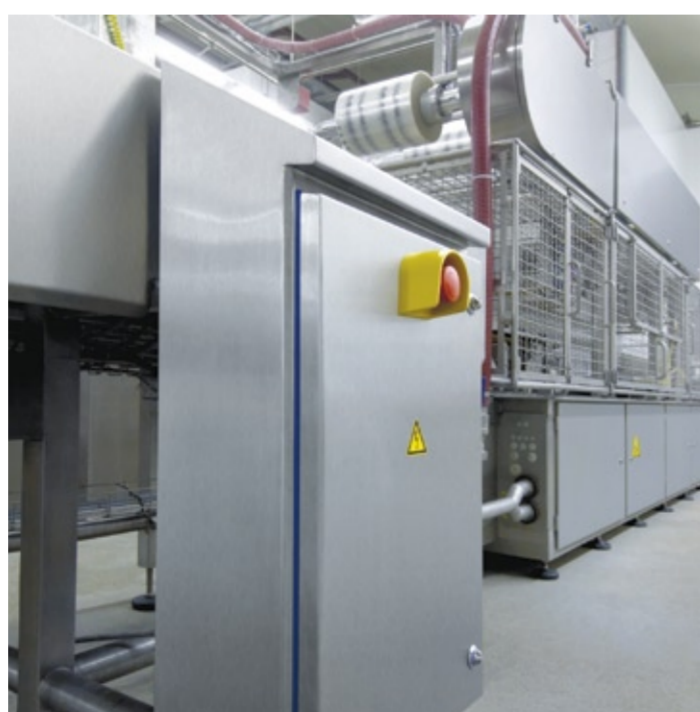
Abb. 1: Hygienic Design für die reinigungsgerechte Gestaltung von Produktionsanlagen in hygienekritischen Prozessen im Food-Bereich
