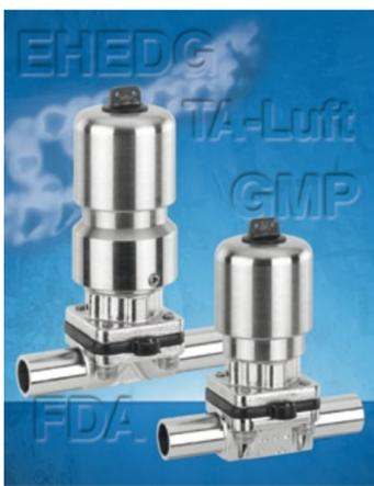
bewährten Gemü-Baukasten und sind damit voll kompatibel zu den bereits bestehenden Baureihen. Die Ventile sind mit EPDM-Membranen bis 10 bar und mit PTFE-Membranen bis 6 bar Betriebsdruck einsetzbar. Sie sind CIP/SIP-fähig und autoklavierbar.
