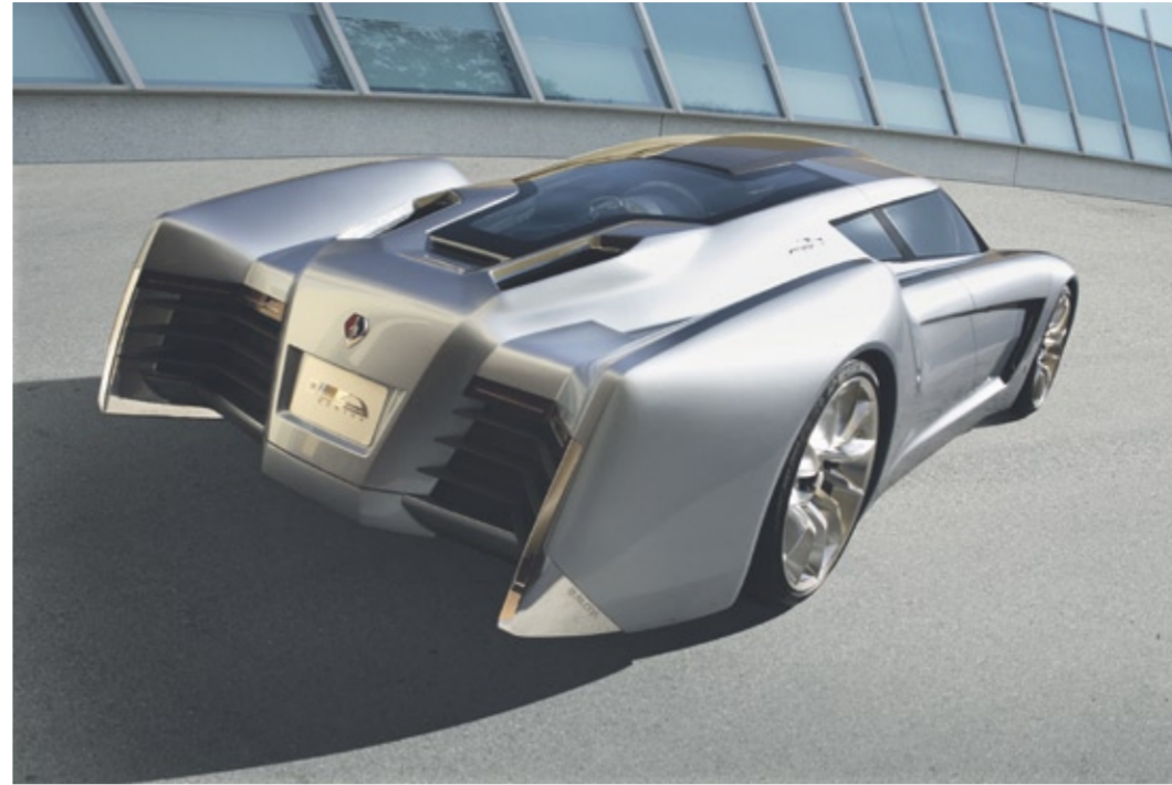
In der Studie Ecojet Supercar von GM wird Lexan GLX-Polycarbonat von SABIC Innovative Plastics für Scheiben und Dachflächen eingesetzt. Das beschichtete Hochleistungspolymer reduziert das Gewicht im Vergleich mit Glas um 50% und bietet höchste optische Qualität, Beständigkeit, Funktionalität und mehr Designfreiheit.
