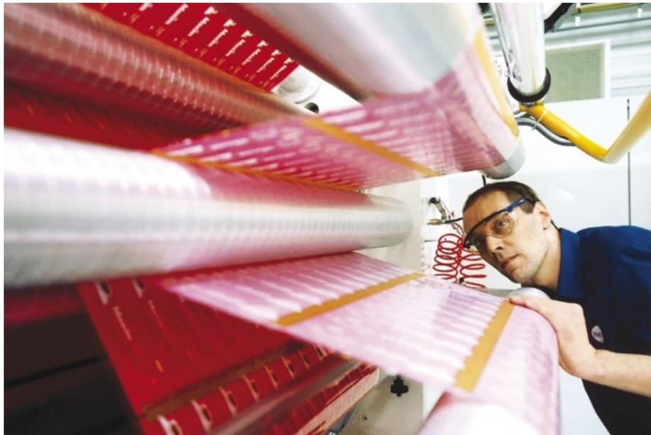
In der Kaschieranlage werden Verpackungsfolien miteinander verklebt.
