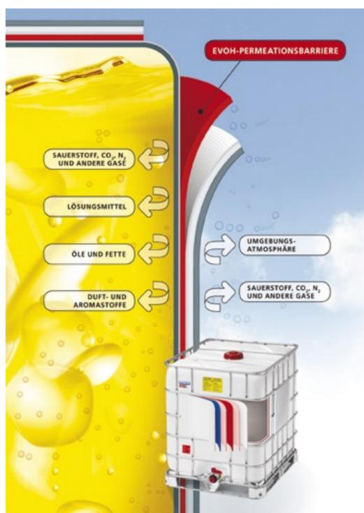
Aufbau und Wirkschema eines sechschichtigen Containers mit eingebauter EVOH-Barriere
