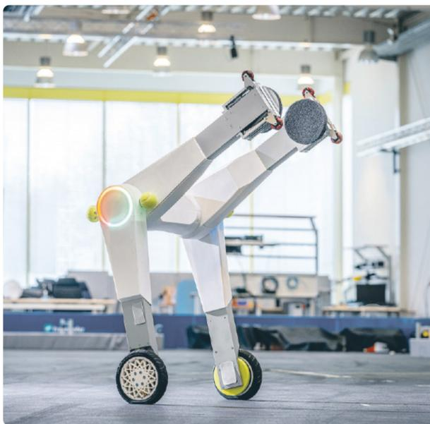
Am Fraunhofer IML wurde der autonome kollaborative Roboter „Evobot“ entwickelt, der unterschiedlichste Hebe- und Transportaufgaben übernehmen kann.
