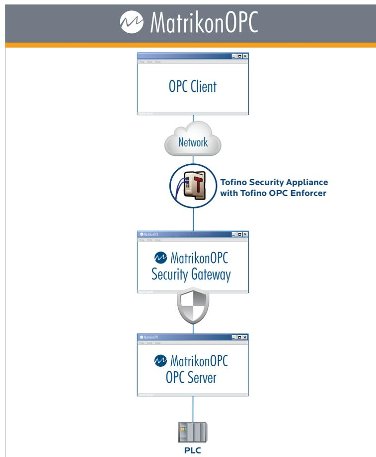
Abbildung 5 – Tofino und MatrikonOPC Security Gateway
