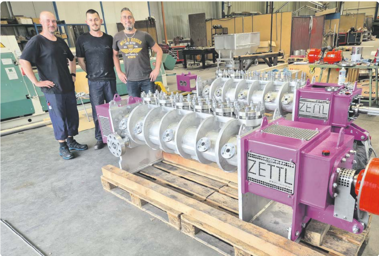
Doppelwellenmischer nach abgeschlossener Funktionsprüfung
