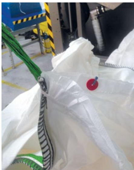
Abb. 3: Die Tags müssen besonders robust sein, denn sie sollten bis zu zehn Durchläufe in den Industrie-Waschmaschinen unbeschadet überstehen.
