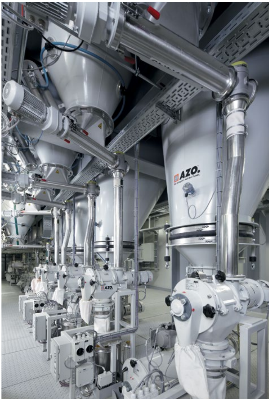
Abb. 4: AZO Wirbelstrom-Siebmaschinen zur Kontrollsiebung
