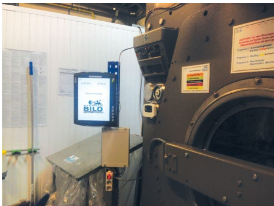
Abb. 2: Vor dem ersten Waschvorgang stattet Stephan Bilo die Big Bags mit RFID-Tags aus – von diesem Moment an bis zur Wiederbereitstellung sind die Transportbehälter lückenlos und eindeutig identifizierbar.
