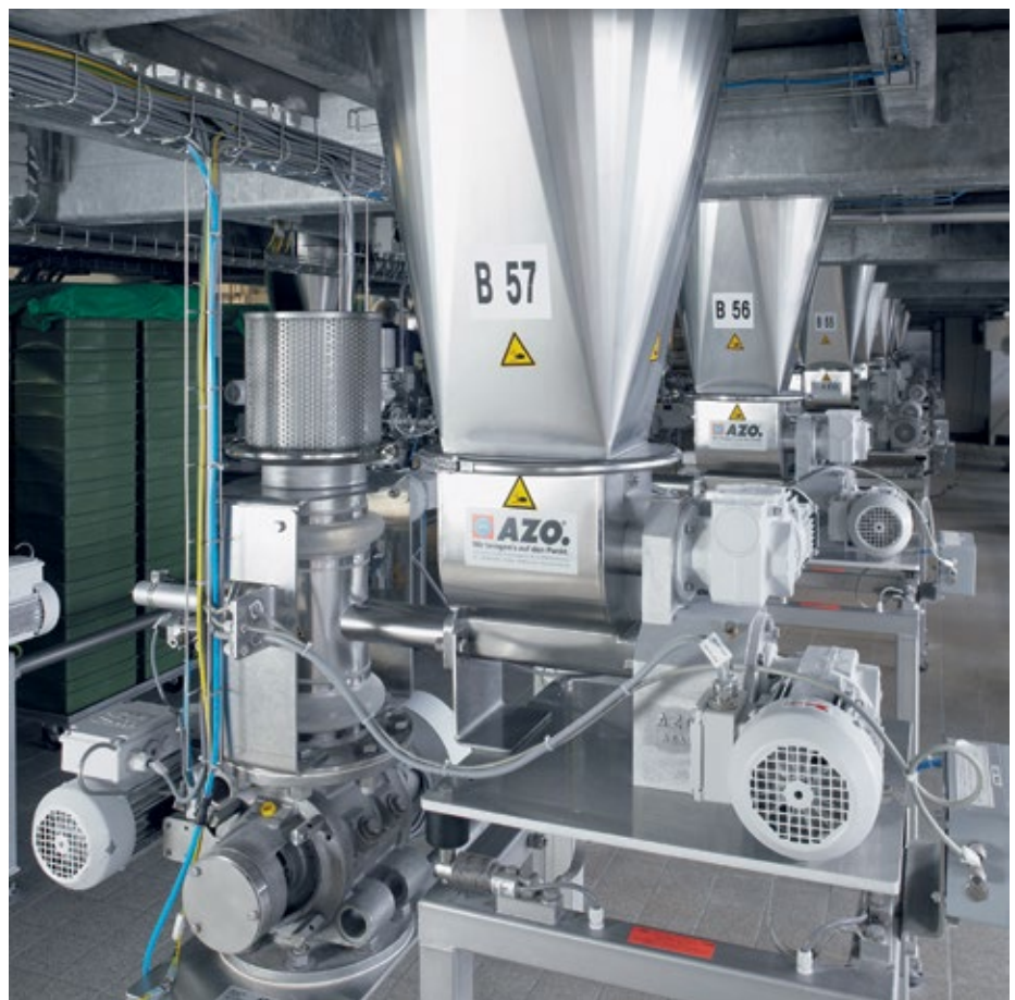
Abb. 2: Azodos zum exakten Wiegen von Kleinmengen
