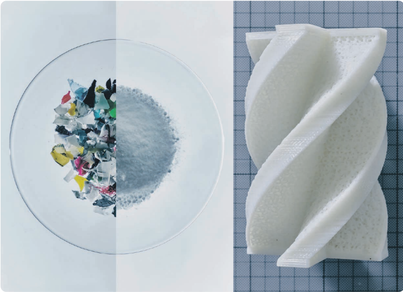
Aevolooop entwickelt eine neue Generation von Kunststoffen, die durch Solvolyse chemisch recycelt werden können und somit vollständig kreislauffähig und wiederverwertbar sind.
