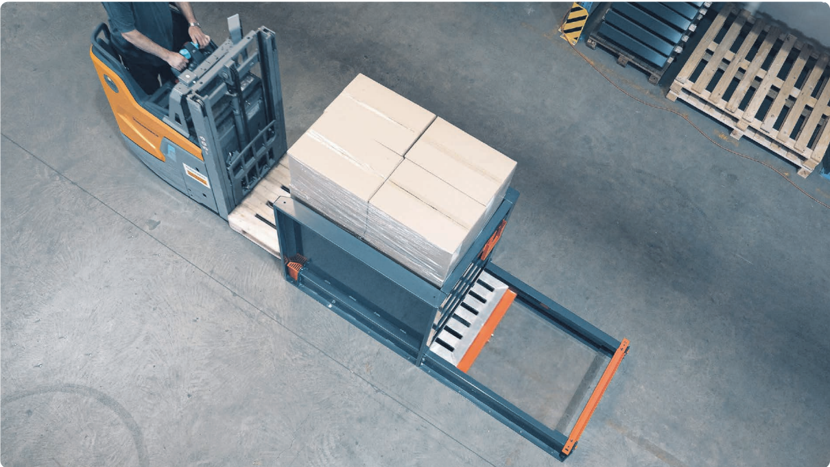
Das Prinzip von SW-Paratus: Mit der Zielpalette wird die Startpalette unter der Ware nach hinten weggeschoben.
