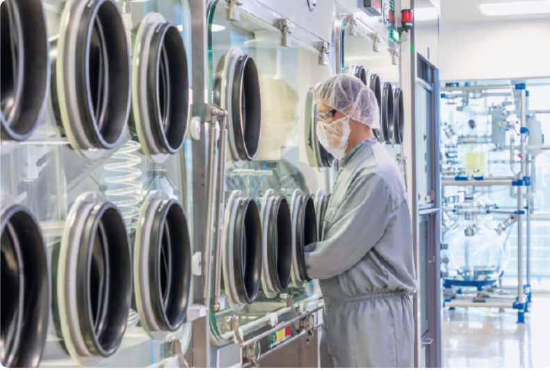
Im Umgang mit den toxischen Wirkstoffen sind ausgefeilte Containment-Konzepte zum Schutz der Mitarbeiter unverzichtbar.
