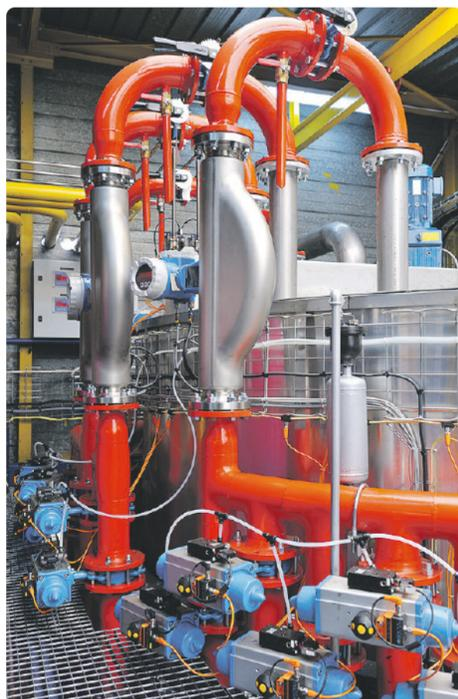
CO<sub>2</sub> unter Druck: In komplexen Prozessumgebungen liefern Coriolis-Systeme zuverlässige Werte – auch bei überkritischen Zuständen.
