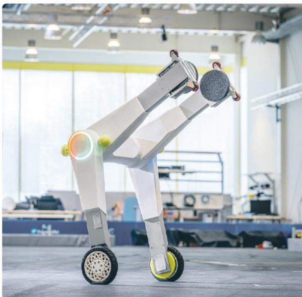
Am Fraunhofer IML wurde der autonome kollaborative Roboter „Evobot“ entwickelt, der unterschiedliche Hebe- und Transportaufgaben übernehmen kann.
