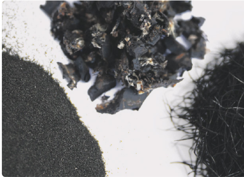
Input- und Outputströme für das Curenergy-Recyclingverfahren (v.l.n.r.): zurückgewonnener Industrieruß (recovered Carbon Black, rCB), zerkleinerte Altreifen, Stahlfäden mit rCB-Anhaftungen
