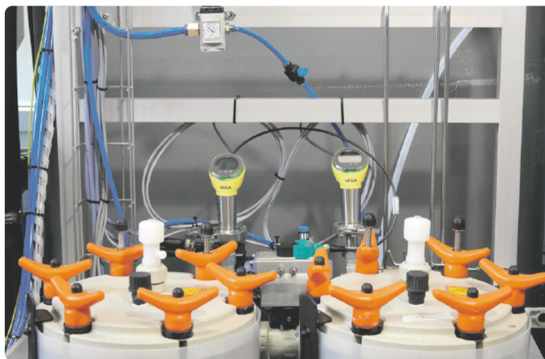
Filtration mit Differenzdruckmessung sicher überwacht: Zwei Vegabar 38 Druckmessumformer zeigen mit ihrer 360-Grad-Leuchtanzeige weithin sichtbar die aktuellen Messergebnisse an.
