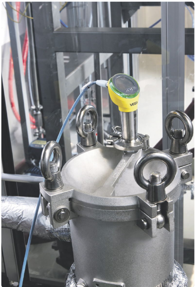
Drei Bauteile, keine Gewinde, FDA-gerecht und optimal für die GMP-Produktion: Die Sensoren sind hygienisch per Tri-Clamp angebunden. So kommen am Prozessanschluss keine Gewinde zum Einsatz.
