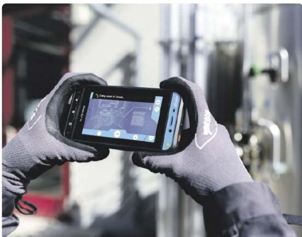
Mit dem Android-Betriebssystem arbeitet das eigensichere Smartphone sehr schnell, sicher und effizient und die Benutzeroberfläche ist intuitiv bedienbar. Das 5-Zoll-Display ist durch das stoß- und kratzefeste Gorilla-Glas extrem widerstandsfähig und lässt sich einwandfrei auch mit Handschuhen bedienen.
