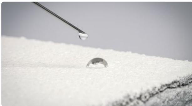
Ober- oder Glättungsputze, die mit wasserabweisenden Vinnapas Dispersionspulvern vergütet sind, sorgen für eine verbesserte Witterungsbeständigkeit und damit Langlebigkeit von Gebäuden.
