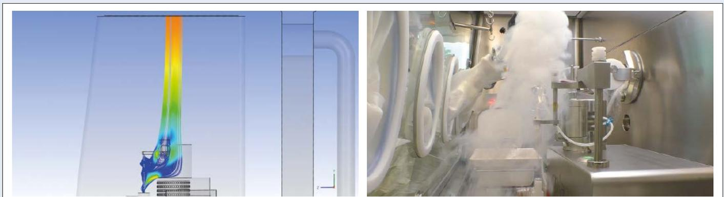
Abb. 2 a+b: Umströmung einer Füllnadel durch Erstluft in einem Isolator. Das linke Bild zeigt den Nachweis im Rahmen einer CFD Simulation (Design) und das rechte Bild den Nachweis bei der Strömungsvisualisierung an der realen Anlage im Rahmen der Qualifizierung
