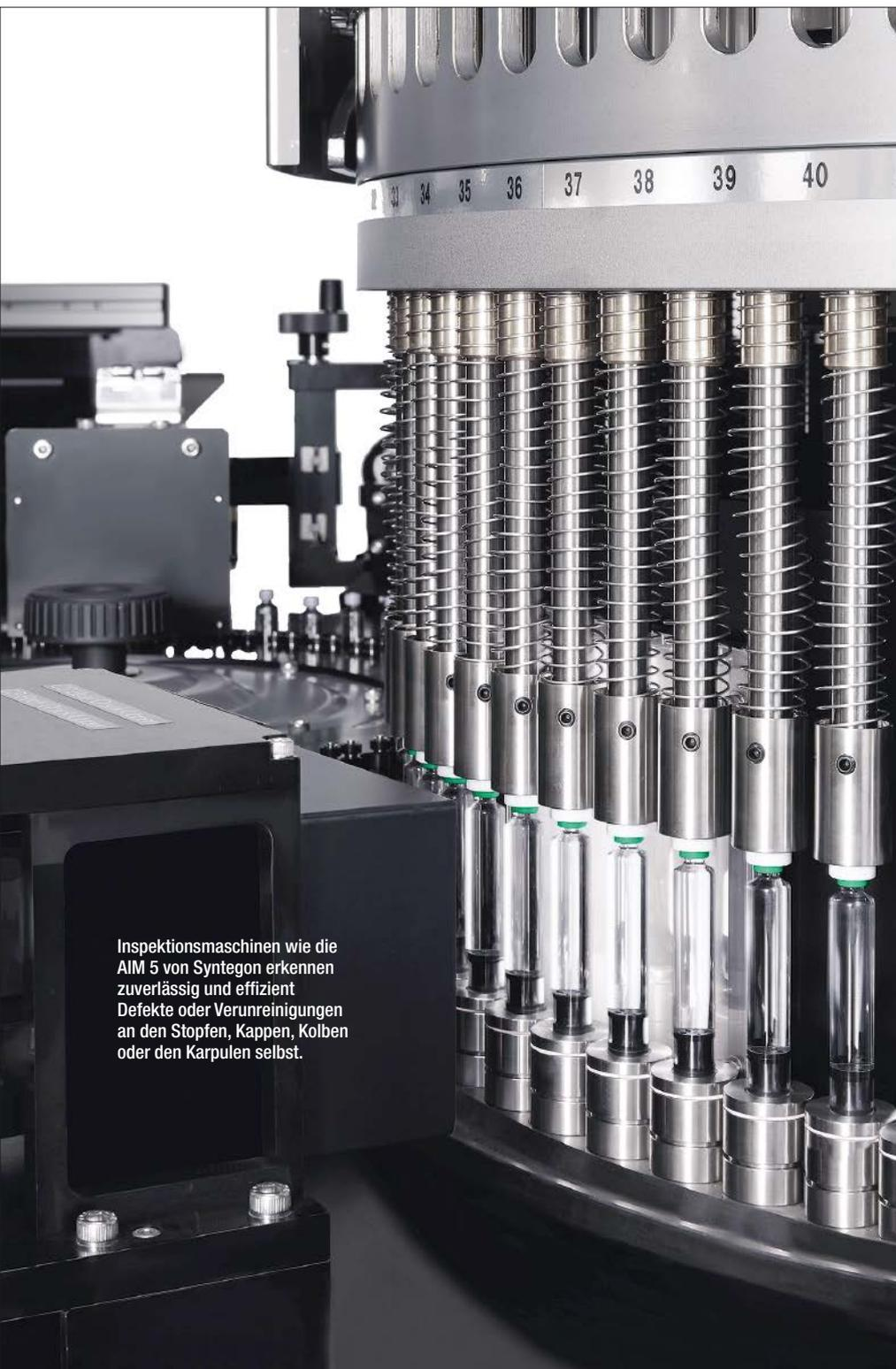
Inspektionsmaschinen wie die AIM 5 von Syntegon erkennen zuverlässig und effizient Defekte oder Verunreinigungen an den Stopfen, Kappen, Kolben oder den Karpulen selbst.
