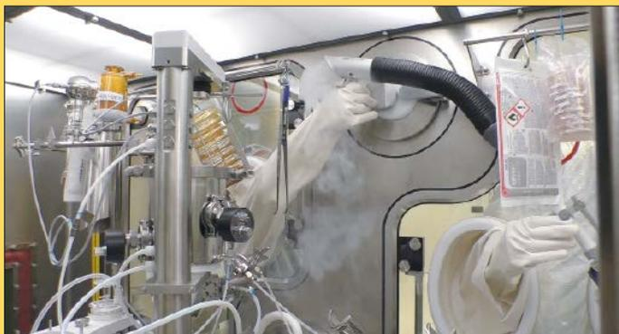
Abb. 5: Handschuheingriff an einem RTP (Rapid Transfer Port) eines Isolators mit Strömungsvisualisierung und Nebelaufgabe oberhalb des Handschuhs. Zusätzlich wird im weiteren Verlauf Nebel unterhalb des Handschuhs aufgegeben.
