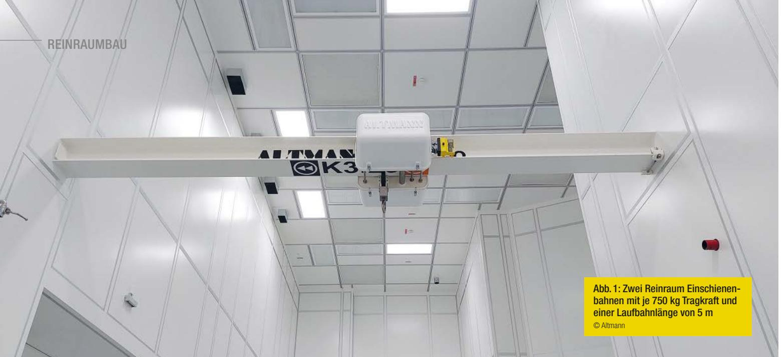
Abb. 1: Zwei Reinraum Einschienenbahnen mit je 750 kg Tragkraft und einer Laufbahnlänge von 5 m
