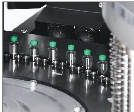
Die Kappen der Karpulen werden mit Kameras geprüft, wie hier an der Station für die seitliche Kappeninspektion einer Syntegon AIM 2023C.
