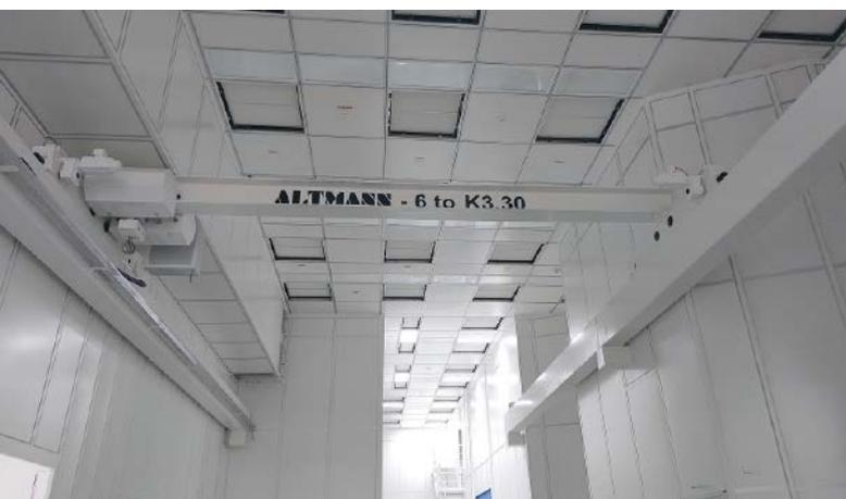
◀ Abb. 3: Reinraum Einträger-Laufkran mit 6 t Tragkraft und einer Spannweite von 6,9 m
